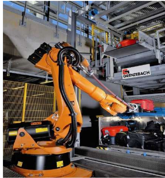
الشكل 2. يقوم الروبوت بتحميل الأكراس تلقائيا في ULD
